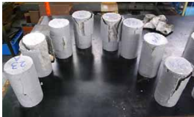
写真 5 アラミド繊維破壊状況 (重ね部から剥離圧壊)
