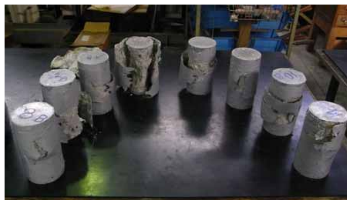
写真 4 バサルト繊維破壊状況 (繊維破断・圧壊)
