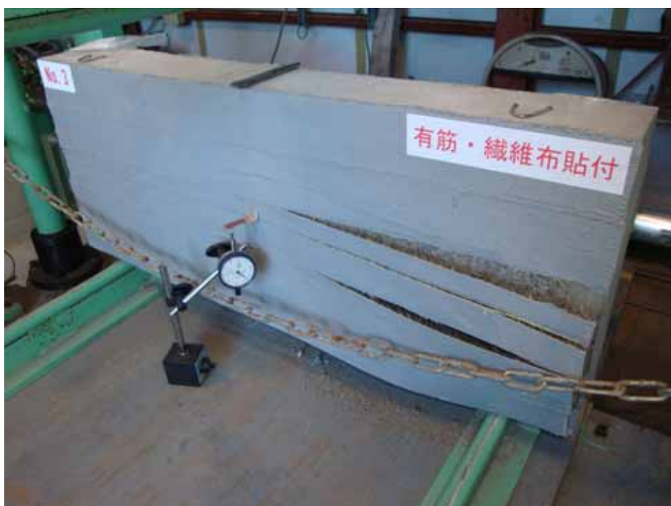
写真-14. 供試体の破壊状況 [d-1：有筋・繊維布貼付]
