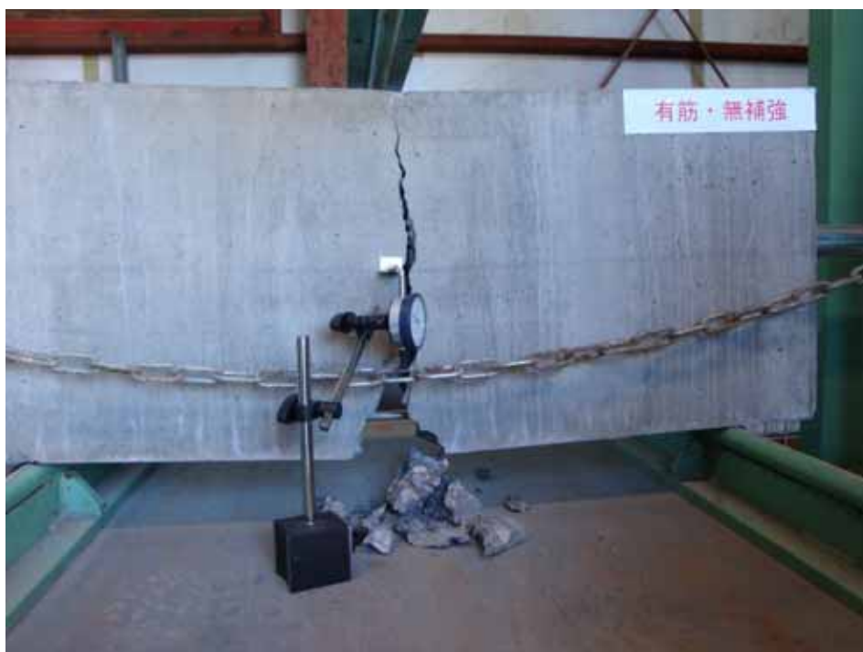
写真-10. 供試体の破壊状況 [c-1：有筋・無補強]
