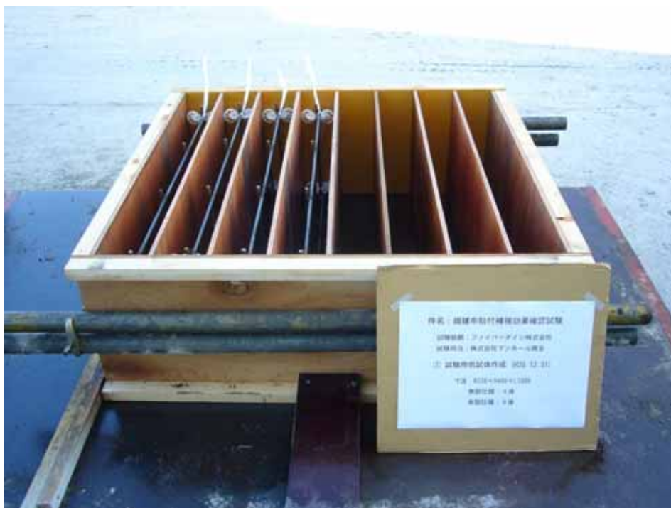
写真-1. 供試体型枠
