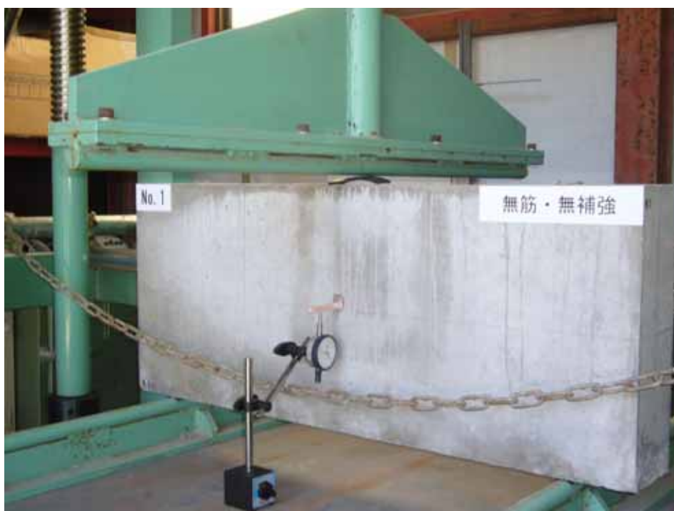
写真-8. ダイヤルゲージ取付部
