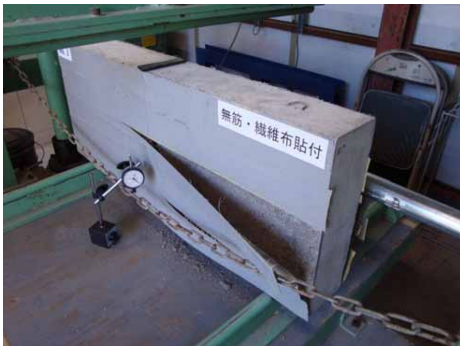
写真-13. 供試体の破壊状況 [b-1：無筋・繊維布貼付]
