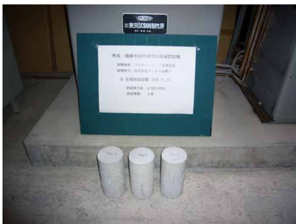
写真-12. 試験日材齢での圧縮強度試験
